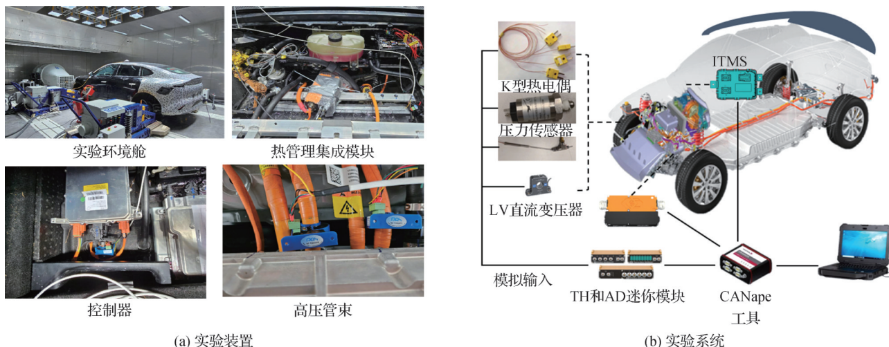
图 4 热管理系统实验
